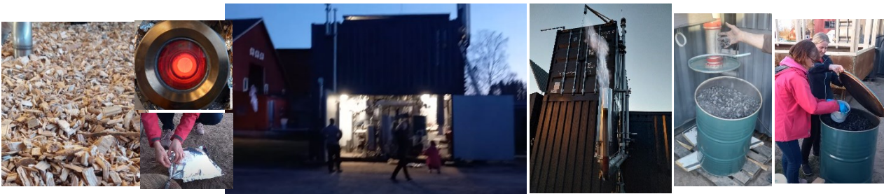
Kuva 11. Pyrolysointi-kaasutusyksikössä käytetty puuhake, muodostunut biohiili, näytteiden keräystä sekä laitteistokontti ajon aikana.
