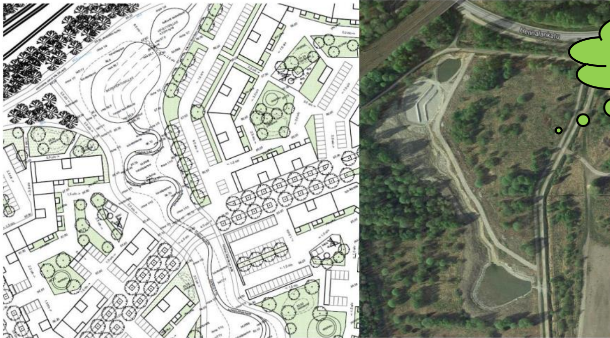
Kuva 2. Länsi-Hennalaan vuonna 2017 laadittu tavoitesuunnitelma (vas.) sekä kesällä 2018 toteutettu hulevesijärjestelmä.
